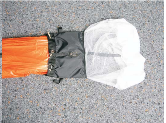
10. Oberes Kappenende in den Innencontainer einlegen.
