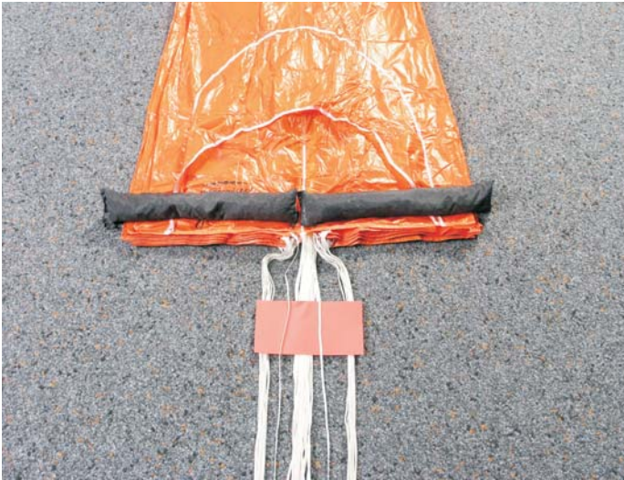
7. Fangleinen 1 und 20 (Piccolo und Annular EVO 20) und Mittelleinen auf kreuzungsfreien Verlauf kontrollieren. (Annular EVO 22/22HG: 1 und 22; Annular EVO 24/24HG: 1 und 24; Annular EVO Tandem/ Tandem HG: 1 und 30)
