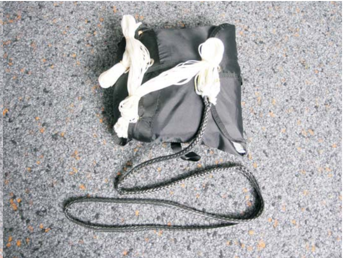
16. Klappen des Hilfsschirmes mit den restlichen Fangleinen verschließen.
