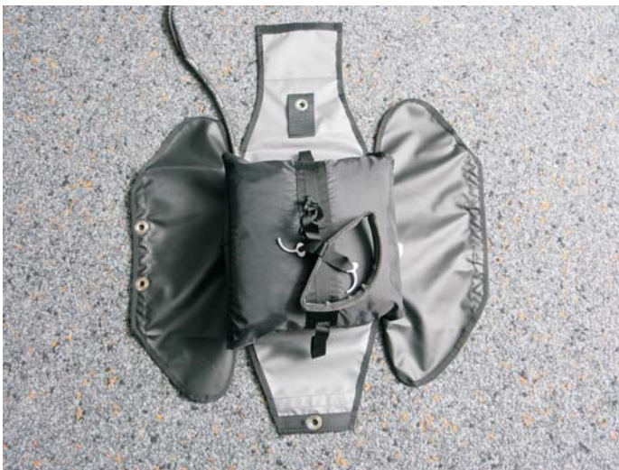
1. Auslösegriff in der mittleren Schlaufe des Innencontainers einschlaufen. Verbindungsleine an der gewünschten Seite aus dem Außencontainer herauslaufen lassen.
