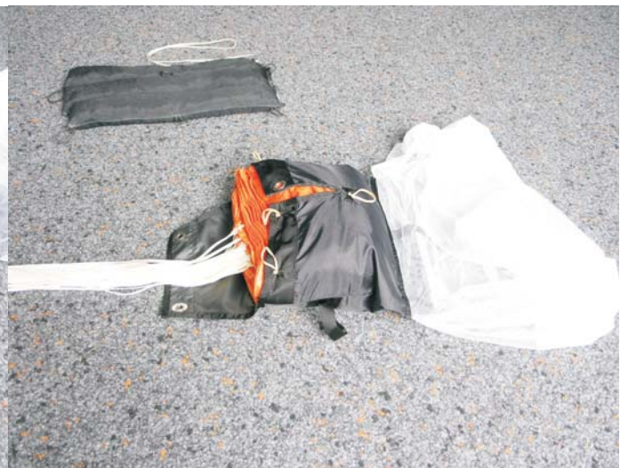
12. S-Schläge in den Innencontainer einlegen.
