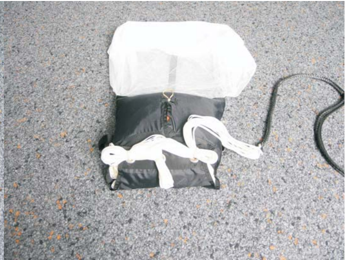
14. Innencontainer mit den Fangleinen verschließen. Zuerst die Mitte, dann Außen. Die letzten 30 cm der Fangleinen werden zum verschließen des Hilfsschirmes verwendet.
