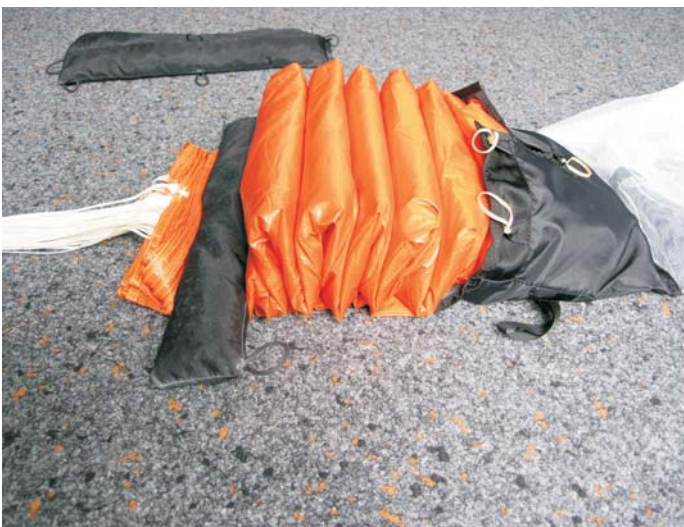
11. Restliche Kappe in kleinen S-Schlägen vor den Innencontainer legen.
