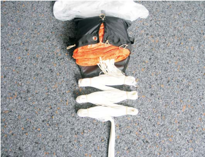
13. Fangleinen in 3x3 Achterschlägen bündeln. Die letzten ca 60 cm Fangleinen nicht bündeln. Achtung es müssen bei jedem Packen sowohl für die Fangleinen als auch für den Innencontainer immer neue Gummibänder verwendet werden!
